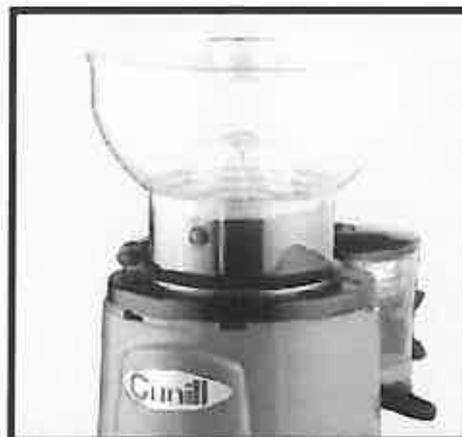
b)-Entfernen Sie den Kaffeebohnen-Trichter (2), indem Sie die Schrauben (3) lösen, die ihn am Regulierteller der Mahlscheiben (4) befestigen.
