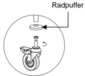
3. Stellen Sie den Servier-/Transportwagen vorsichtig auf den Boden und stellen Sie sicher, dass die vier Lenkrollen den Boden berühren. Sie können die Nivellierung des Servier-/Transportwagens mit Hilfe der Lenkrollen vornehmen, indem Sie diese ein- oder ausdrehen. Fixieren Sie diese nun mit Hilfe der Kontermuttern.
