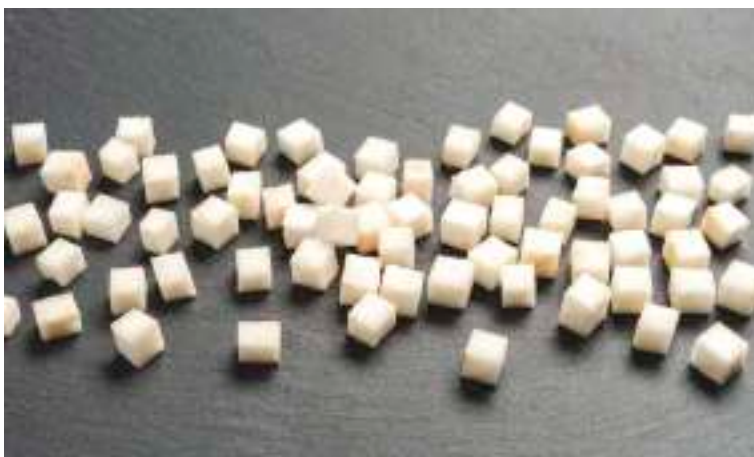
Sellerie gewürfelt mit Würfelschneideeinrichtung 6 x 6 x 6 mm Celery diced with dicing screen 6 x 6 x 6 mm
